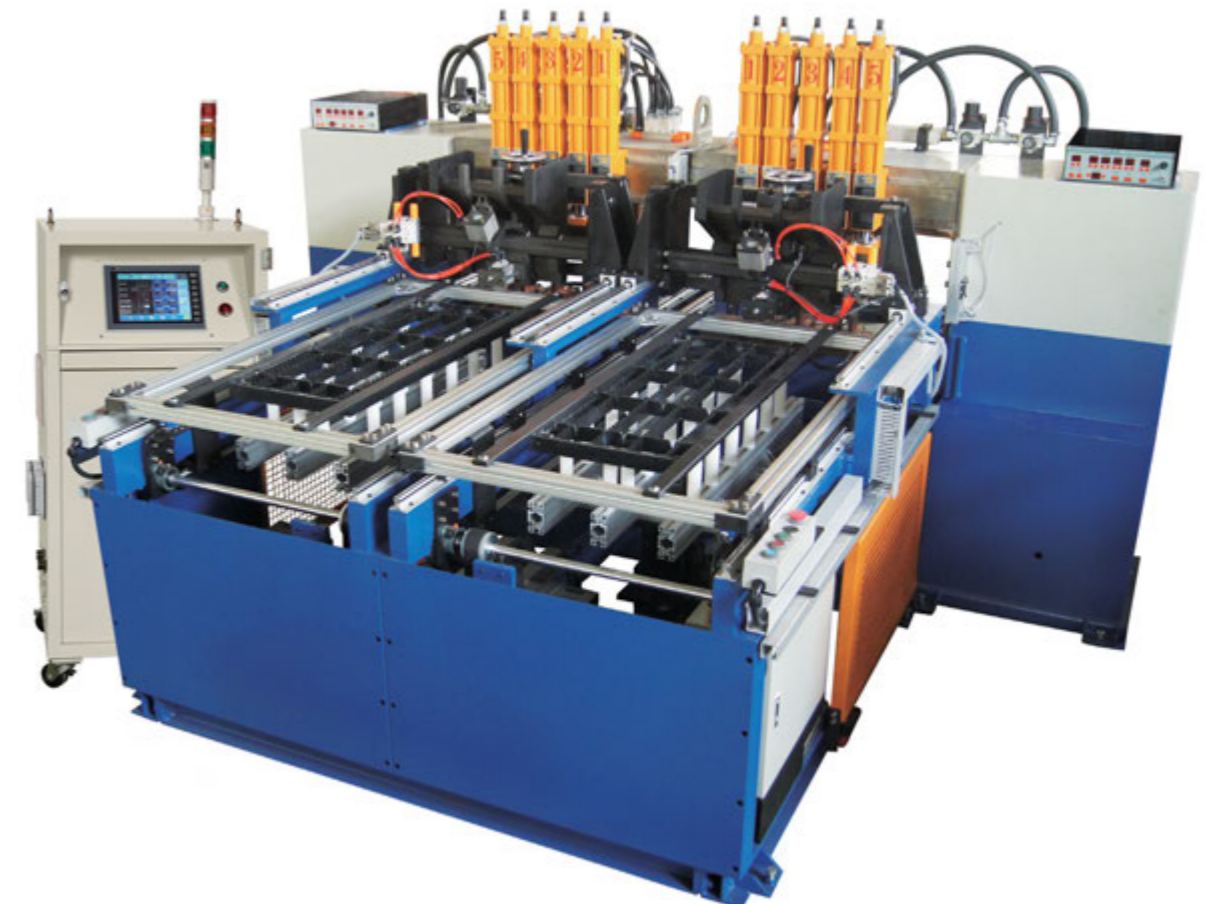
SA-1500-DL-1. ДВА НЕЗАВИСИМЫХ СТОЛА + АВТОЗАГРУЗКА ПОПЕРЕЧНЫХ ПРУТКОВ
