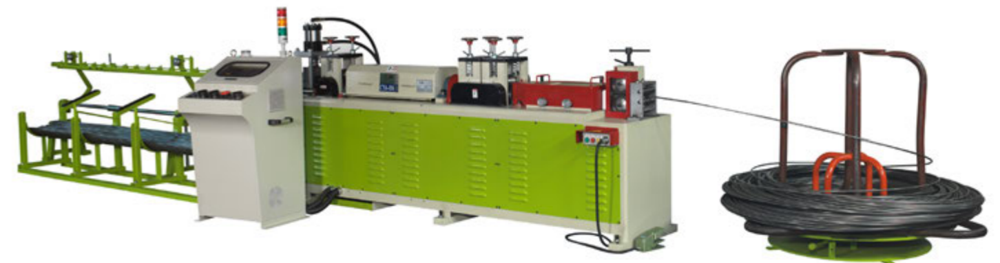
СУА-106В. СТАНОК СЕРИИ «В» ДЛЯ ПРАВКИ ПРОВОЛОКИ 10–14 мм
