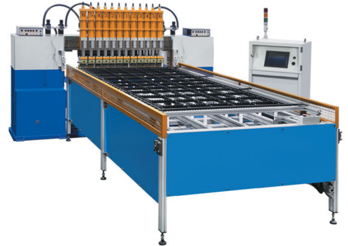
SA-1500-DL-1. ДВА НЕЗАВИСИМЫХ СТОЛА + АВТОЗАГРУЗКА ПОПЕРЕЧНЫХ ПРУТКОВ
